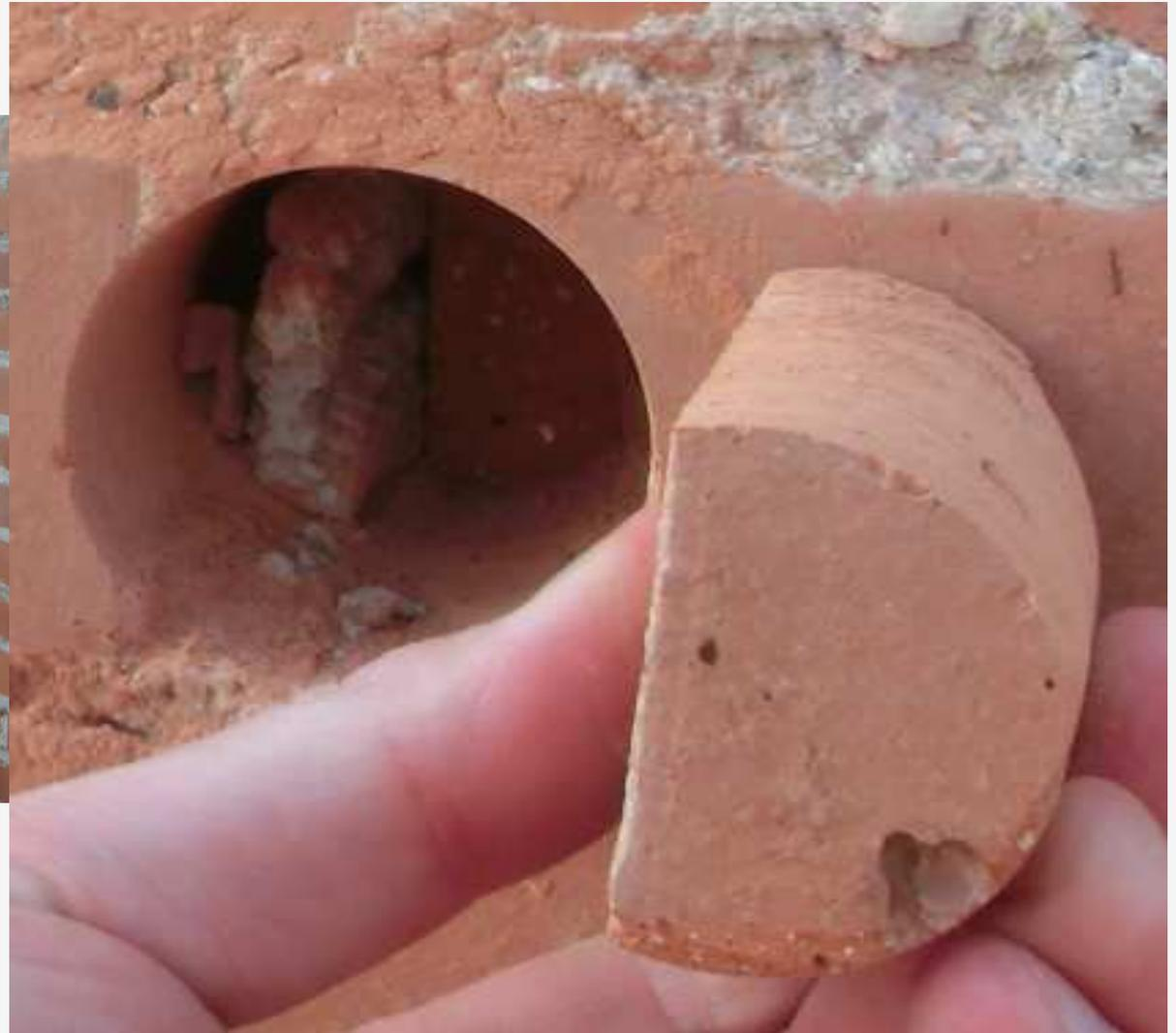
Bohrkernentnahme zur Erstellung einer Feuchte- und Salzbilanz.
